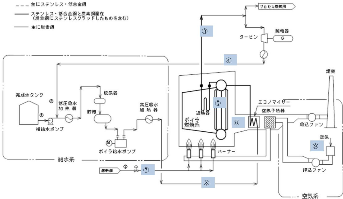
図. ボイラ装置工程図
